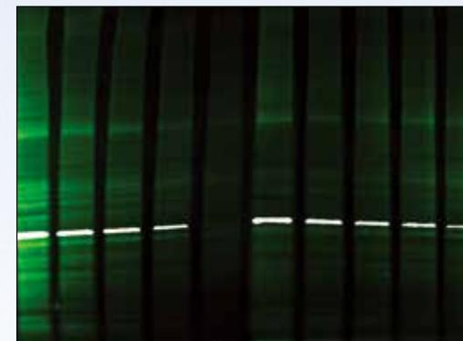
Figure 5. AzureRedとChemiluminescent Western Blotによる総タンパク質の同時検出。HeLaライセートの2倍連続希釈液をSDS-PAGEで分離し、PVDF膜に転写した。セミドライブロッティングが完了した後、メンブレンをAzureRedトータルプロテインステインで染色した。その後、マウス抗GAPDHとのインキュベーションの前に、Azure Chemiluminescent Blot Blocking Bufferでブロッキングを実施した。プロットをAzure Blot Washing Bufferで3回洗浄した後、Azure goat anti-mouse HRP二次抗体とインキュベートした。化学発光シグナルをRadiance ECL基質で検出した。基質をインキュベートした後、プロットを画像化し、全タンパク質の染色とGAPDHタンパク質のオーバーレイを作成した。AzureRedは緑、GAPDHは灰色で表示される。
