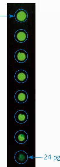
**Figure 12.** AzureSpectra-800で標識した抗体の2倍連続希釈液をニトロセルロースのドットプロットでスポットし、800nmチャネルで20秒間撮像した。
